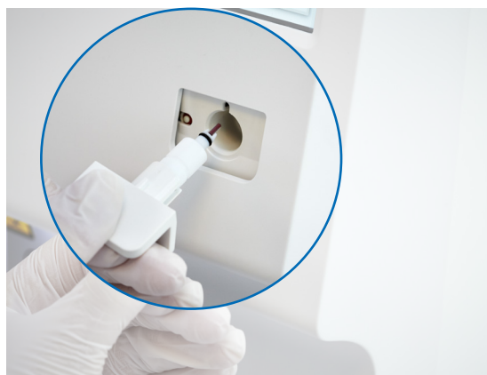
Mikrokapilarni adapter (MPA) omogućava brz i jednostavan način za dobivanje rezultata kompletne krvne slike (CBC).
